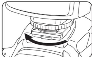
4. ロックリングを図のように回して、締めつけます。
